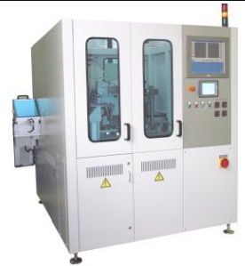
P 在一个载板上完成整个叠片过程
